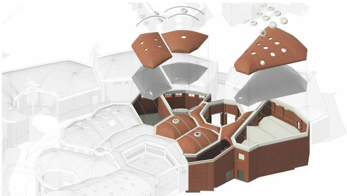
Fig. 22 | Despiece 3D de las cubiertas de los bloques 6 y 7. | Esploso 3D delle coperture dei blocchi 6 e 7.
