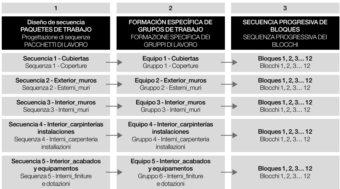
Fig. 3 | Esquema de gestión de las secuencias de construcción. | Schema di gestione delle sequenze costruttive.
