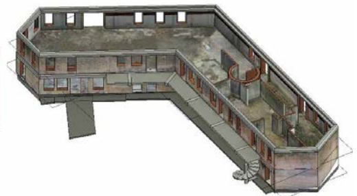
Fig. 57 | Vista 3D de los muros exteriores del bloque 14 con inserción de los fotoplanos correspondientes y sección horizontal 3D con inserción de los fotoplanos de pavimentos y muros interiores. | Vista 3D delle pareti esterno del blocco 14 con inserimento dei relativi fotopiani e sezione orizzontale 3D con inserimento dei fotopiani relativi a pavimenti a pareti interne.
